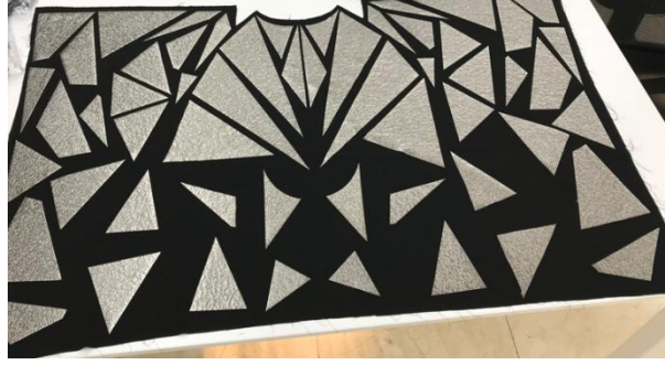
Görsel 18. Polyester siyah zemin kumaş üzerine, parametrik tasarım ilkeleri doğrultusunda geometrik formlarda lazer kesim uygulanmış parlak suni deri parçalarının laminasyonu ile oluşturulan yüzey denemesi.
