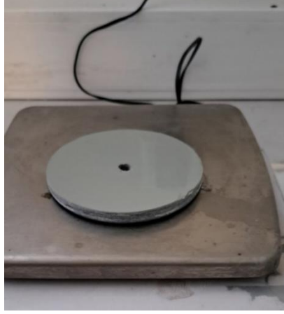
Görsel 3. Jelkot kaplı CTP numune, 2025
